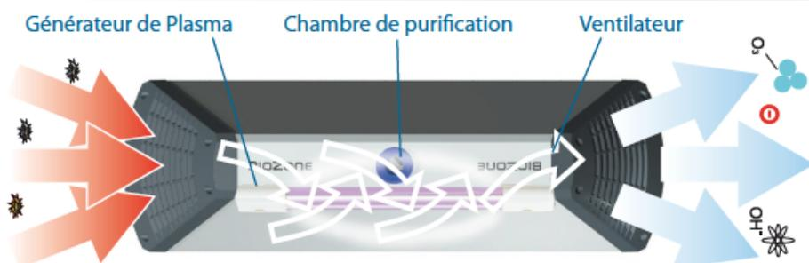
L'air n'a pas besoin de traverser l'appareil pour être purifié car le plasma d'oxygène créé par l'appareil est dispersé dans la pièce.
